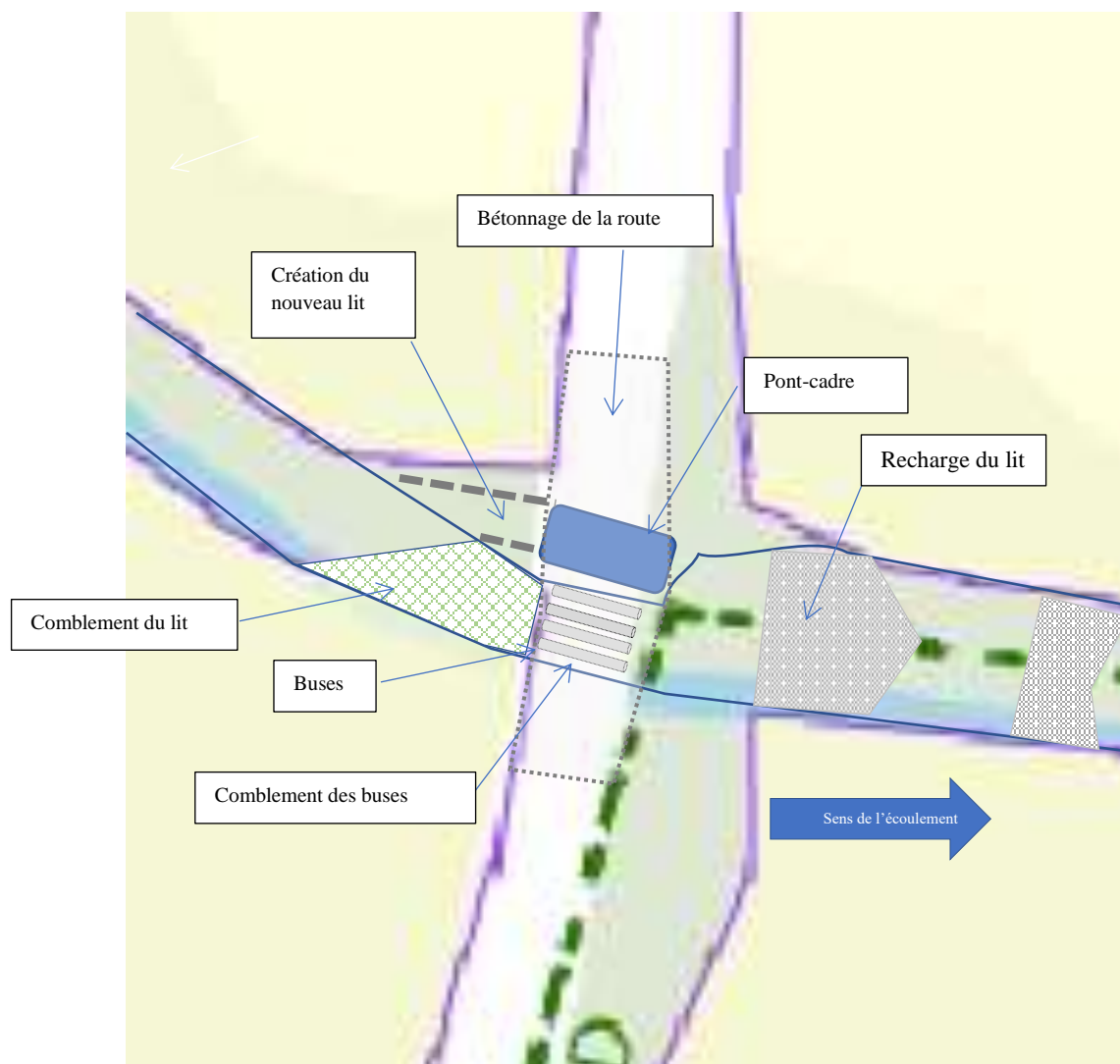
Figure 46 : Localisation des travaux en vue de dessus
