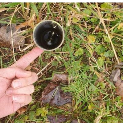
Piézomètre sur la Bonniere : Remonter du niveau dans l'ensemble de la nappe alluviale qui permet de faire une réserve d'eau
